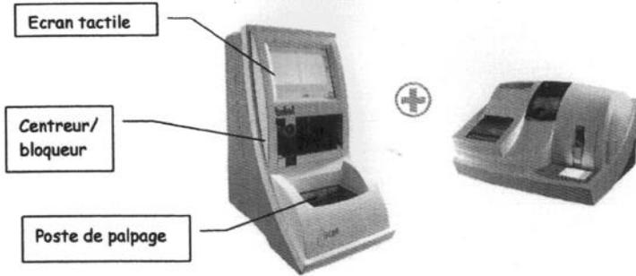
Un centreur/bloqueur AXCELL est associé à une meuleuse automatique pour permettre de tailler un verre à la forme d'une monture.
