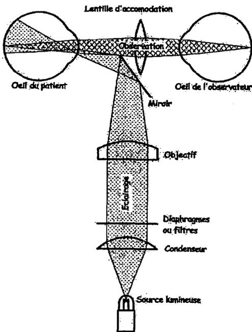
Le fond de l'œil du patient est éclairé par un faisceau issu de la source 11 et coulé par le miroir 3. Ce fond de l'œil devient alors source lumineuse pour l'observation.
